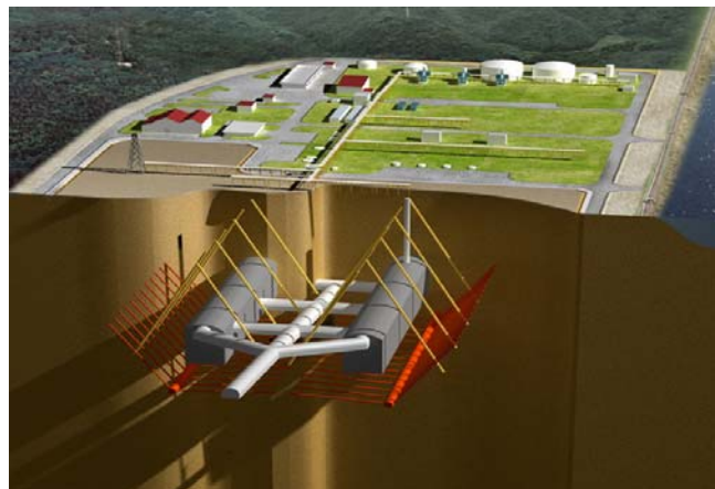
Underground LNG storage cavern
